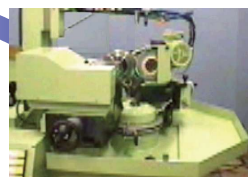
ミクロンオーダーで旋回する高精度 旋回機構により、砥石の先端を正確 に円弧に修正します。
