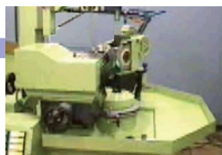
ミクロンオーダーで旋回する高精度 旋回機構により、砥石の先端を正確 に円弧に修正します。
